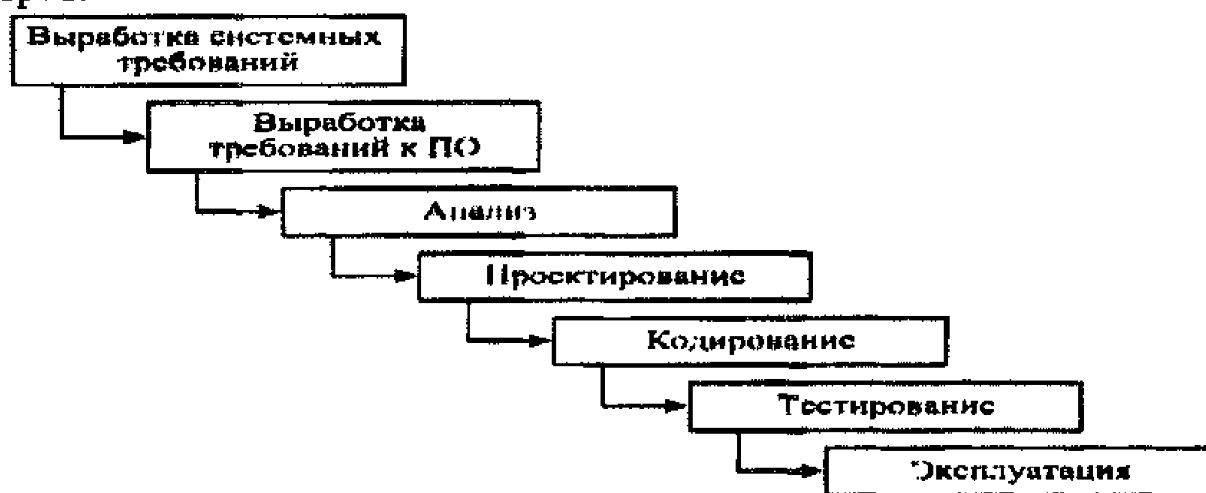
Рис. 3.1.1. Пример традиционного цикла проекта Plan-driven по разработке программного обеспечения
