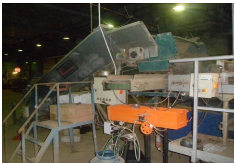
Рис. 4. Установка для гидроподавления почвенной пыли в воздухе рабочей зоны
