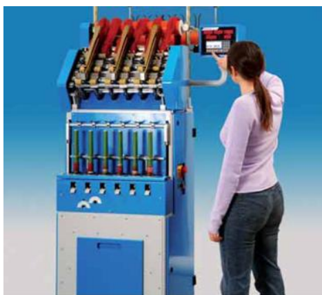
18-расм. Ring-Lab- Кичик ўлчамли табиий, кимёвий ва улар аралашасидан ип йигириш машинаси
