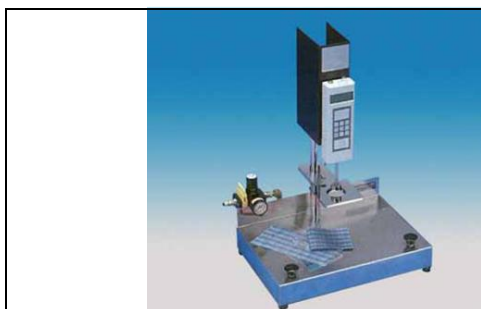
24-расм. Матони қаттиқлигини ўлчайдиган асбоб
