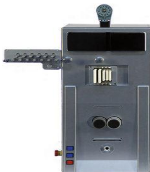
6-расм. COVATEST-пилта, пилик ва ипни нотекислигини аниқлаш асбоби
