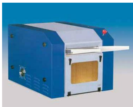
6-расм. Тола анализатори. 100 г тола таркибидаги чиқиндиларни аниқлашда қўлланилади.
