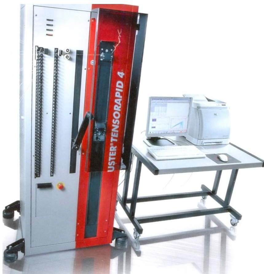
3-расм. Ипни узулиш кучи, узулишдаги узайишини ва узулиш вақтини аниқлаш асбоби Калава ипларнинг қуйидаги сифат кўрсаткичларини аниқлайди:
