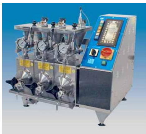
29-расм. Fabric Colour - Трикотаж маҳсулотларига ранг бериш қурилмаси
