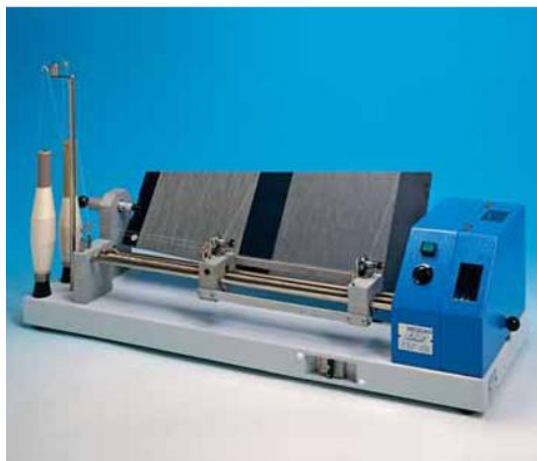
16-расм. KIT TWO Оргонолептик усулда ип нуқсонларини текшириш учун қурилма
