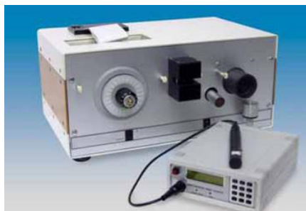
11-расм. 1м ипдаги тукдорликни аниқлайдиган асбоб.
