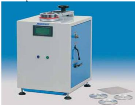
26-расм. Water Proof-матони босим остида сув ўтказувчанлигини аниқлаш асбоби
