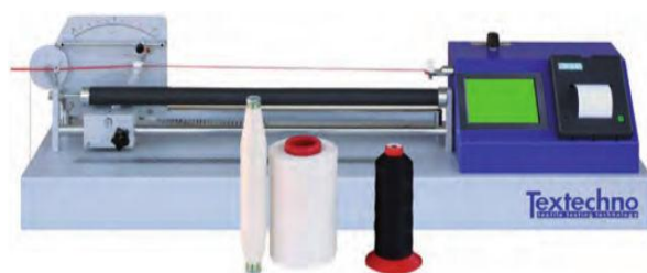
4-расм. Ип бурамини аниқлаш асбоби Маълум 1 м узунликдаги ипдаги бурамлар сонини аниқлаш учун ишлатилади
