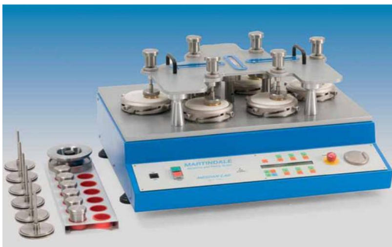
23-расм. Martindale- Ҳамма турдаги матони емирилиши ва туганакларини аниқлаш асбоби
