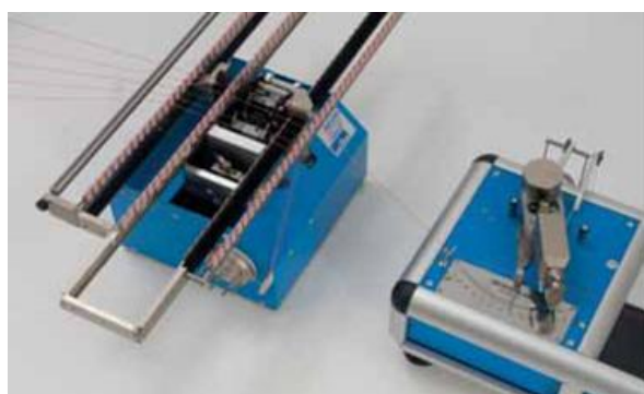
13-расм. Автоматик равишда ип найчаларини алмаштириш қурилмасы
