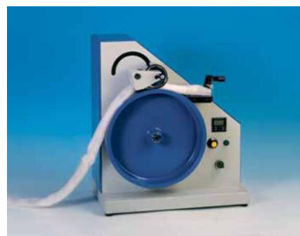
7-расм. Мотовило Пилта ва пиликни чизиқли зичлигини аниқлашда қўлланилади. Барабан тезлиги 100м/мин. Хатолиги \pm 1\text{ см}
