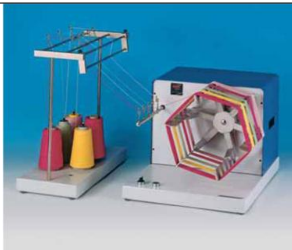
9-расм. Ип ўраш мотовилоси Маълум узунликдаги ипни чизикли зичлигини аниқлашда қўлланилади. Маълум узунликдаги ип ўралганда автоматик тарзда тўхтайди. Ип ўраш барабани диаметри: 1 м, 1 ярд ёки 1.5 ярд UNI EN ISO 2060, ASTM D 1907, ASTMD2260-BS2010 талаблари асосида яратилган. Электр қуввати: 220 В, 50/60 Гц, однофазное Оғирлиги: 40 кг Ўлчамлари: (Д) 900 x (Ш) 600 x (В) 600 мм
