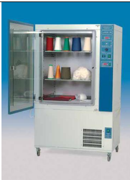
8-расм. Тўқимачилик маҳсулотларини ISO стандарти асосида намлигини ростловчи кондиционер Climatest
