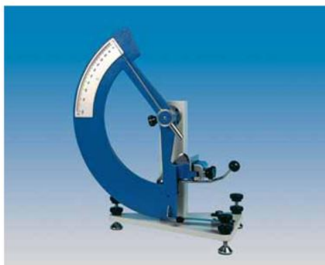
28-расм. Elmendorf-матоларни ва сунй чармларни йиртилишга қаршилигини аниқлайдиган қурилма
