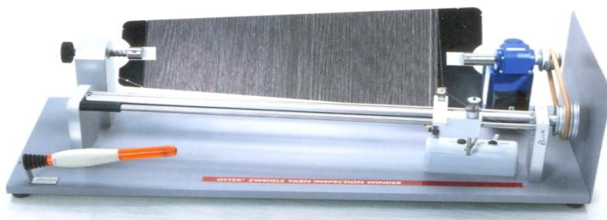
5-расм. USTER ZWEIGLE YARN INSPECTION WINDER- Мотовило оргонолептик усулда ипни сифати аниқланади
