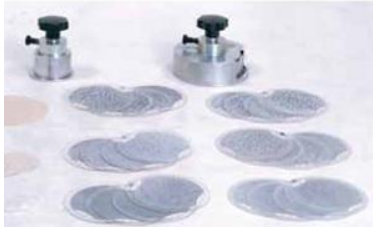
23-расм. Martindale- Ҳамма турдаги матони емирилиши ва туганакларини аниқлаш асбоби
