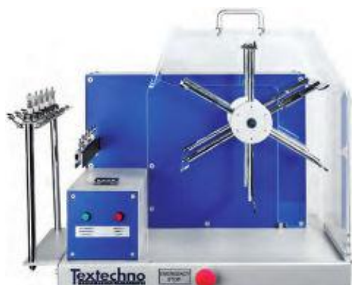
3-расм. YARN REEL TT- Электрон мотвила Маълум узунликда ипни номерини аниқлаш учун ишлатилади
