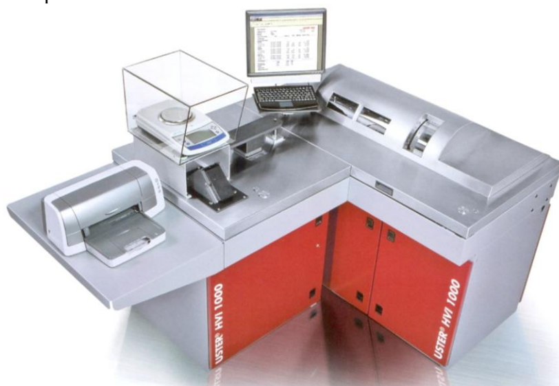
1-расм. Толанинг тўлиқ хосса кўрсаткичларини аниқлашда ишлатиладиган USTER HVI 1000 MI1000 асбоби
