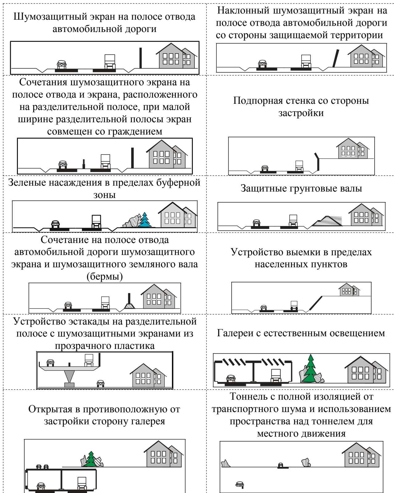
Рисунок 8.6. – Схемы наиболее часто реализуемых шумозащитных сооружений
