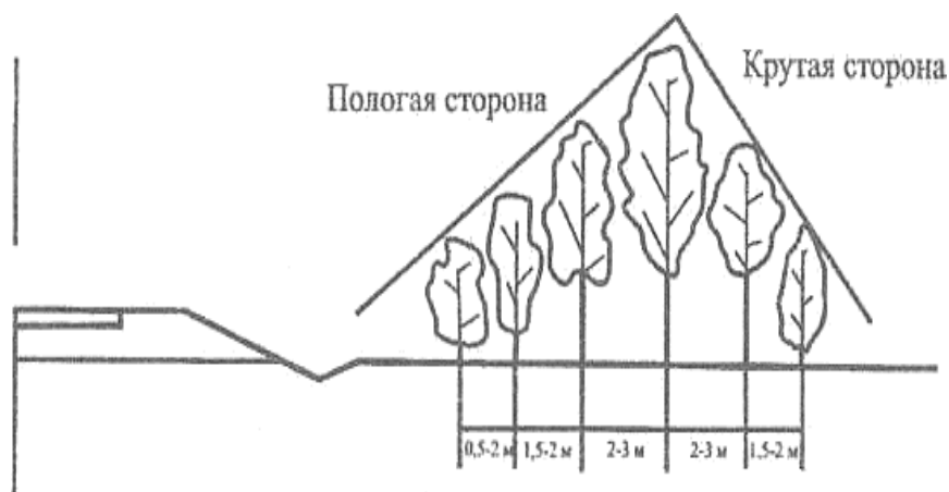
Рис. 3.7. Схема шумогазопылезащитных насаждений:
