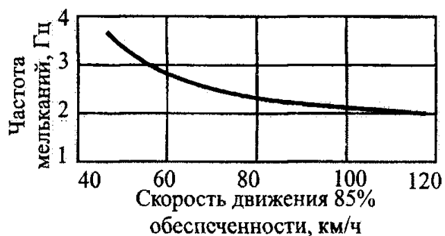
Рис. 4.52. Взаимосвязь скорости движения и частоты мелькания штрихов и разрывов прерывистой линии разметки.
