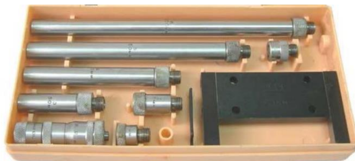
24-rasm. Mikrometrik icho'lchagich NM 600-0.01 GOST 10-80 etalon skoba va o'lchashni belgilangan chegara o'rnatgichi.
