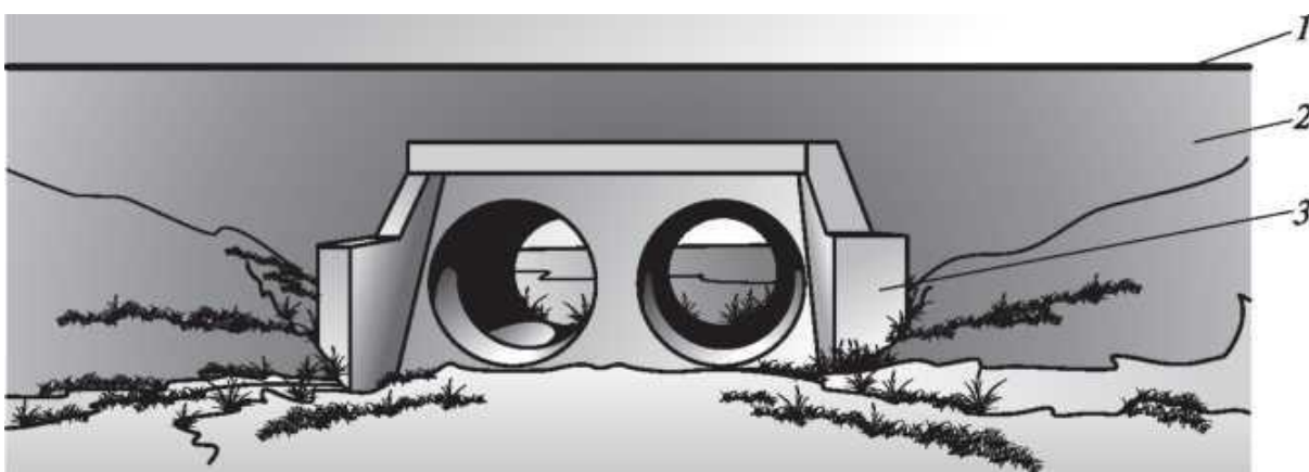
1.1. Rasm. Suv o‘tkazuvchi quvurning yo‘l ko‘tarmasidagi ko‘rinishi: 1-Yurish qismi satxi; 2-Yo‘l ko‘tarmasi; 3-Quvur kallagi qismlari
