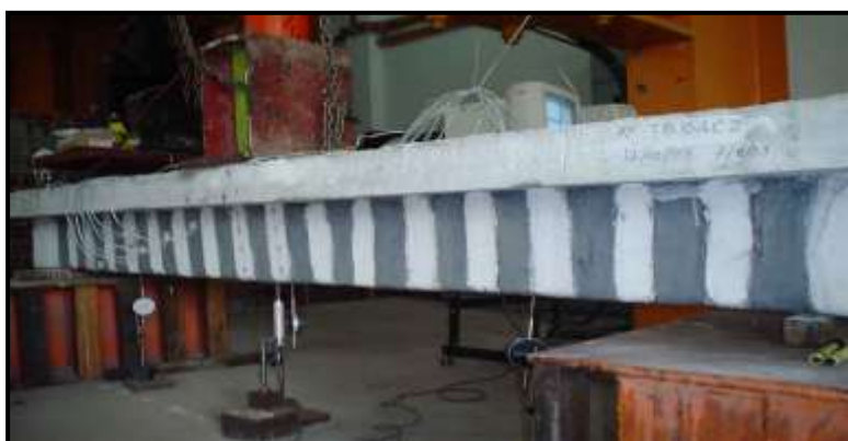
8.30-rasm. Tavr shaklli to‘sinni yig‘iq yuk ostida egilishga sinash
