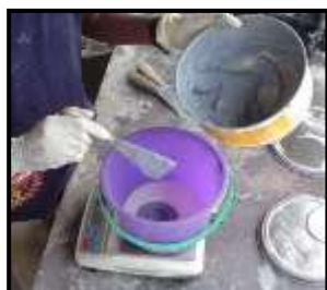
v) A va V komponentlarni o'lchash
