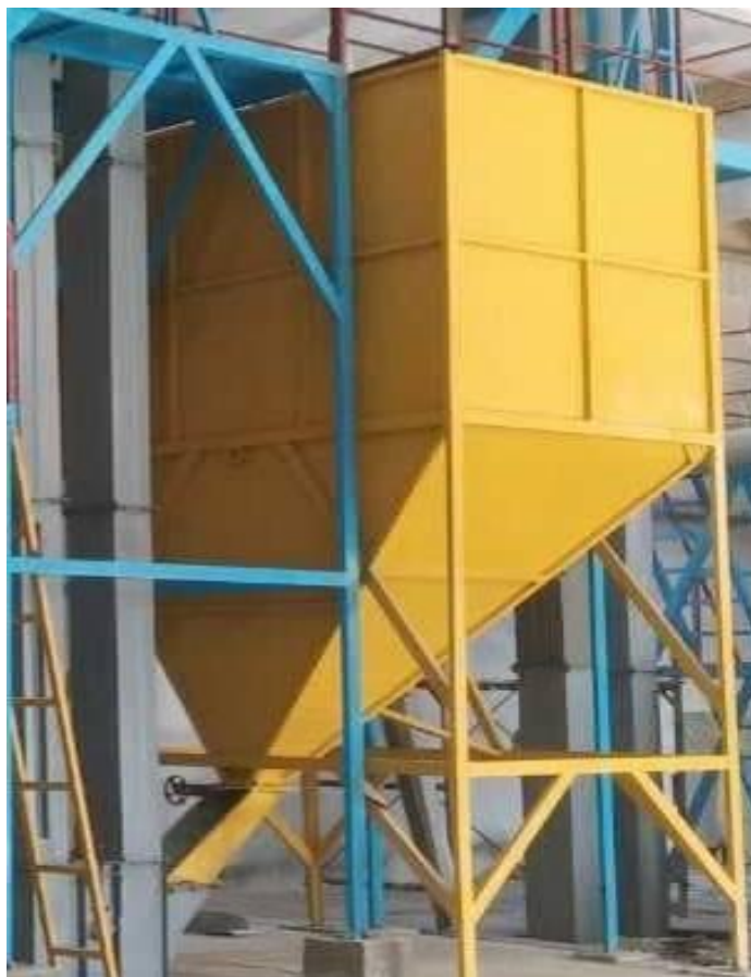
1.12-rasm. Tuksizlantirilgan urugʻlik chigitlarni vaqtincha saqlash va dozalash uchun ishlab chiqilgan BNOS rusumli bunker-taʼminlagichni umumiy koʻrinishi
