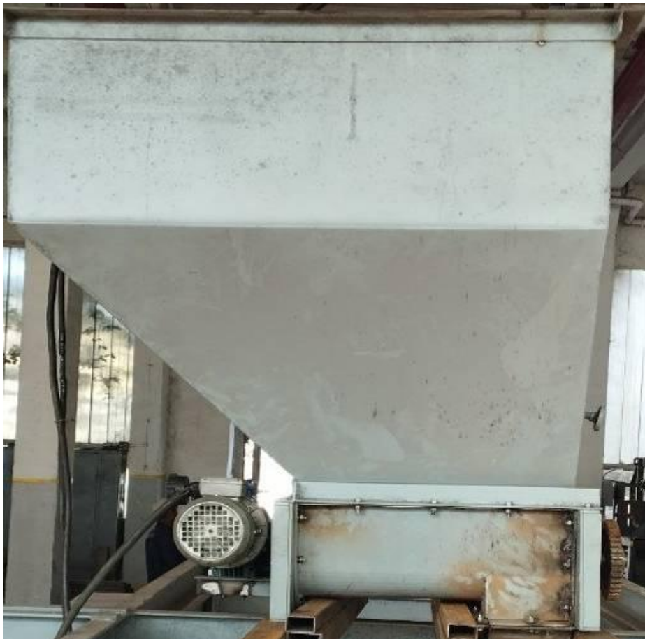
3.4-rasm. Tayyorlangan tajriba universal bunker dozatorini umumiy ko'rinishi
