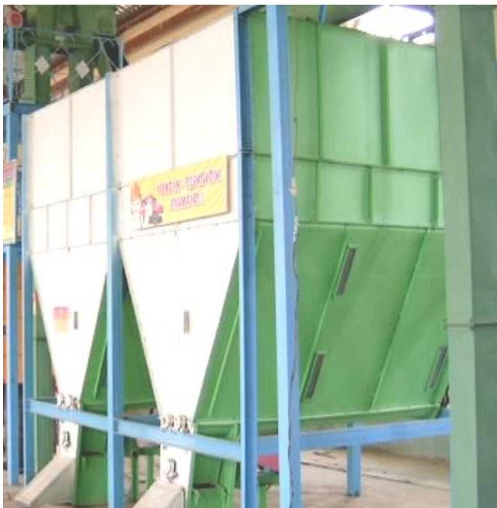
1.13-rasm. Tukli paxta urug'lik chigitini tayyorlash uchun texnologik liniyaga kiritilgan BDOS bunker-dozalagichining umumiy ko'rinishi.
