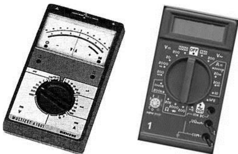
5.2 – rasm. Analogli va displeyli o'lchash asboblari
