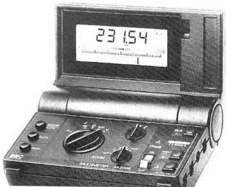
5.6 rasm. Multimetrning raqamli va kvaziraqamli displeyi
