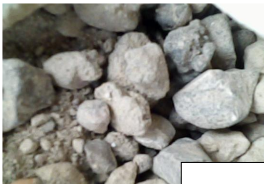
4.28-расм. Горизонтал тоштутгичда ажратилган ёт аралашмалар
