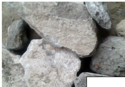
4.28-расм. Горизонтал тоштутгичда ажратилган ёт аралашмалар
