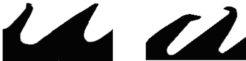
1.1-расм. Оғир аралашмалар ва металл жисмлар таъсирида жин arrasининг шикастланиши кўрсатилган
