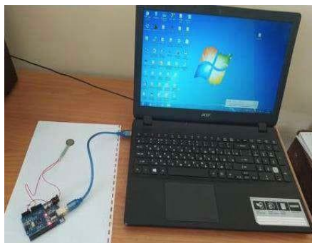
3.7-rasm. ARDIUNO markali zarba kuchini o'lchovchi pribor.
