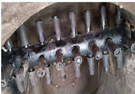
4.3-rasm. Toshtutgich qurilmasining kirish quvuriga oʻrnatilgan elastik qoplamali qoziqchali baraban.
