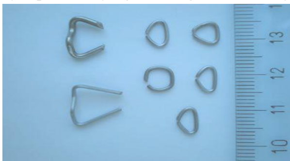
3.10-rasm. Jag'-yuz xirurgiyasida ishlatiladigan material shaklini saqlash effekti bo'lgan nikelid titan qotishmasidan yasalgan konstruksiyalar
