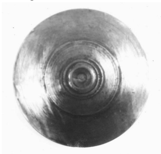
7.14-rasm. Qattiq qotishmaBK6-po‘lat40XHMI kompozitsiyasiya, matritsa diametri 150 mm,
