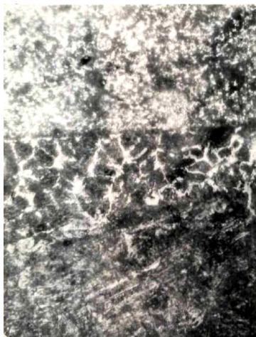
5.3-rasm. Molibden asosidagi qotishma MoTiC-po‘lat stal 40X kompozitsiyasi termik ishlov berilgandan keyingi mikrostrukturasi. O‘tish qatlami materiali Su–Ni asosidagi sim. x100 kattalashtirilgan
