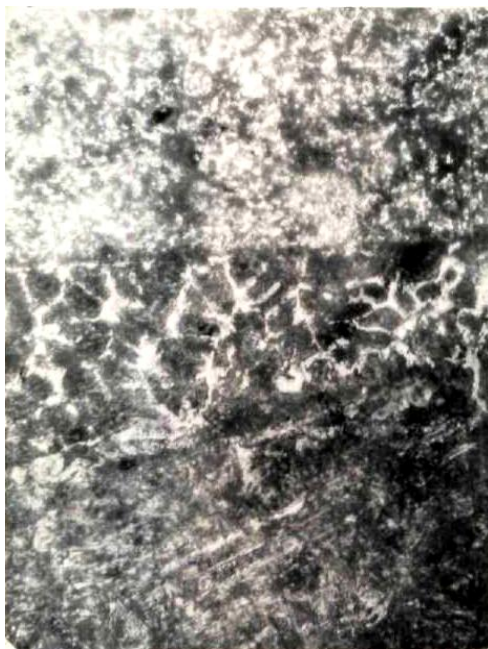
7.20-rasm. Molibden asosidagi qotishma: MoTiC-po‘lat stal 40X kompozitsiyasi termik ishlov berilgandan keyingi mikrostrukturasi. O‘tish qatlami materiali Su–Ni asosida sim. x100 kattalashtirilgan
