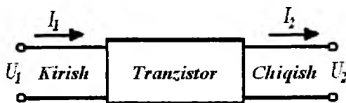
4.18-rasm. Tranzistorni chiziqli to'rt qutblik sifatida ko'rsatilishi.
