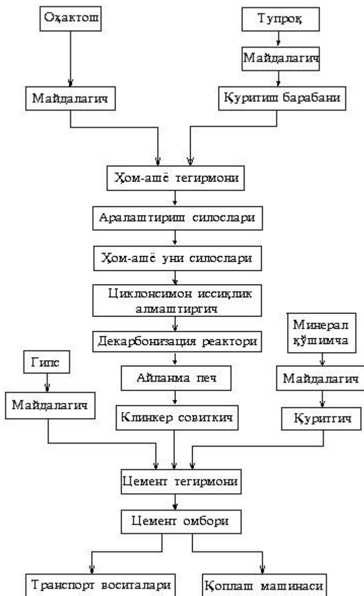
1.2-расм. Цемент етиштиришнинг қуруқ усули схемаси
