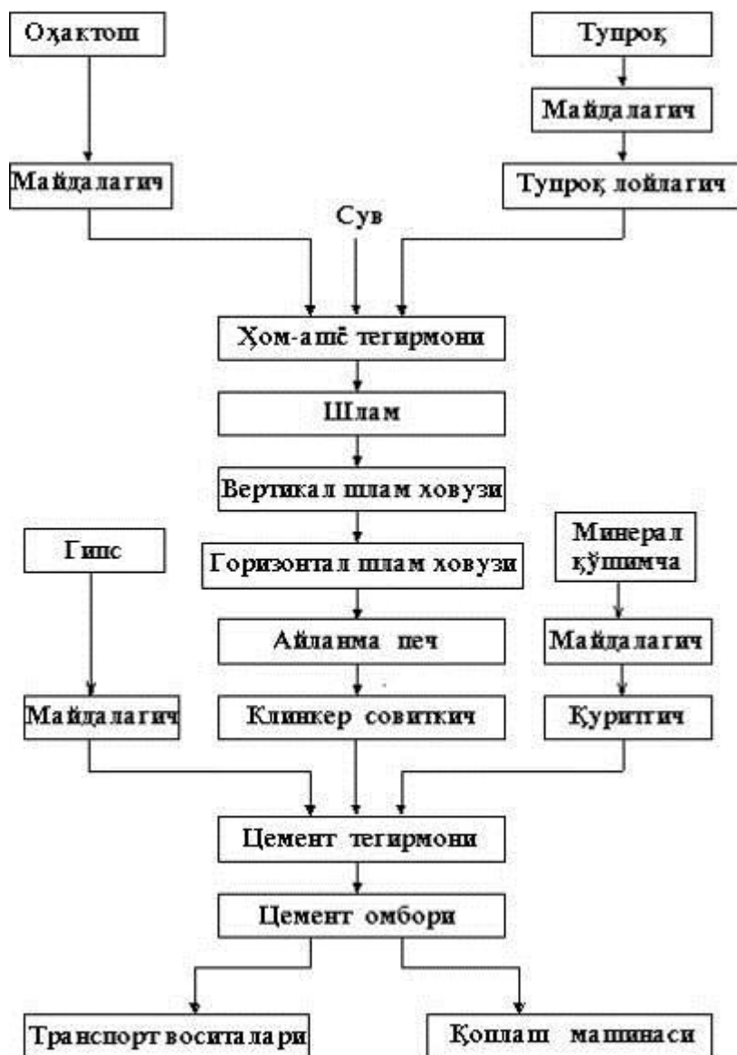
1.1-расм. Цемент етиштиришнинг ѓўл усули схемаси
