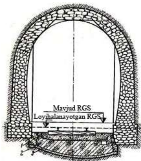
6.41-rasm. Yo'lni pasaytirishdagi teskari ravoqning konstruksiyasi:
