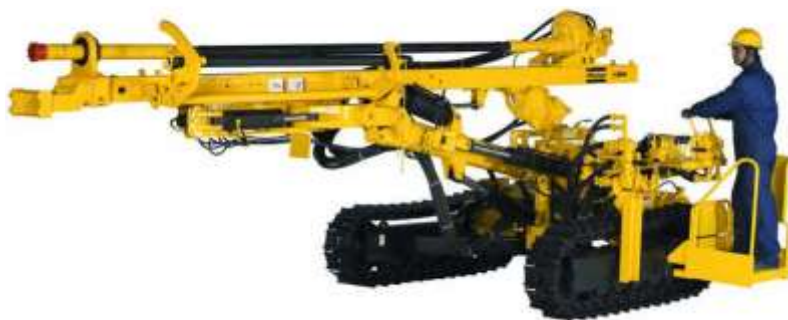
Atlas Copco (Shvetsiya) firmasining vertikal burg'ilash stanogi
