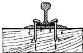
4.9-rasm. Qaytarma tortuv toklarining relslardan chiqib ketishi sxemasi
