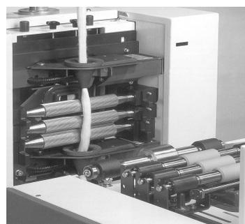
Рис.79. Вытяжной прибор IDF
