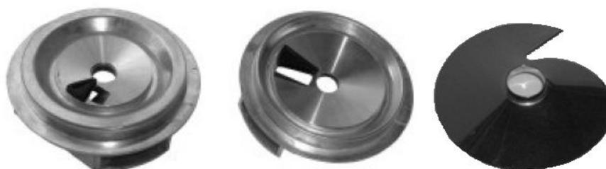
Рис. 209. Сепараторы пневмомеханических прядильных машин.
