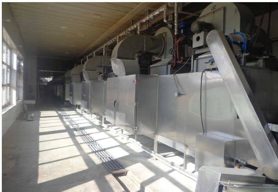
1.4.1-rasm. Konvektiv quritish qurilmasi.
