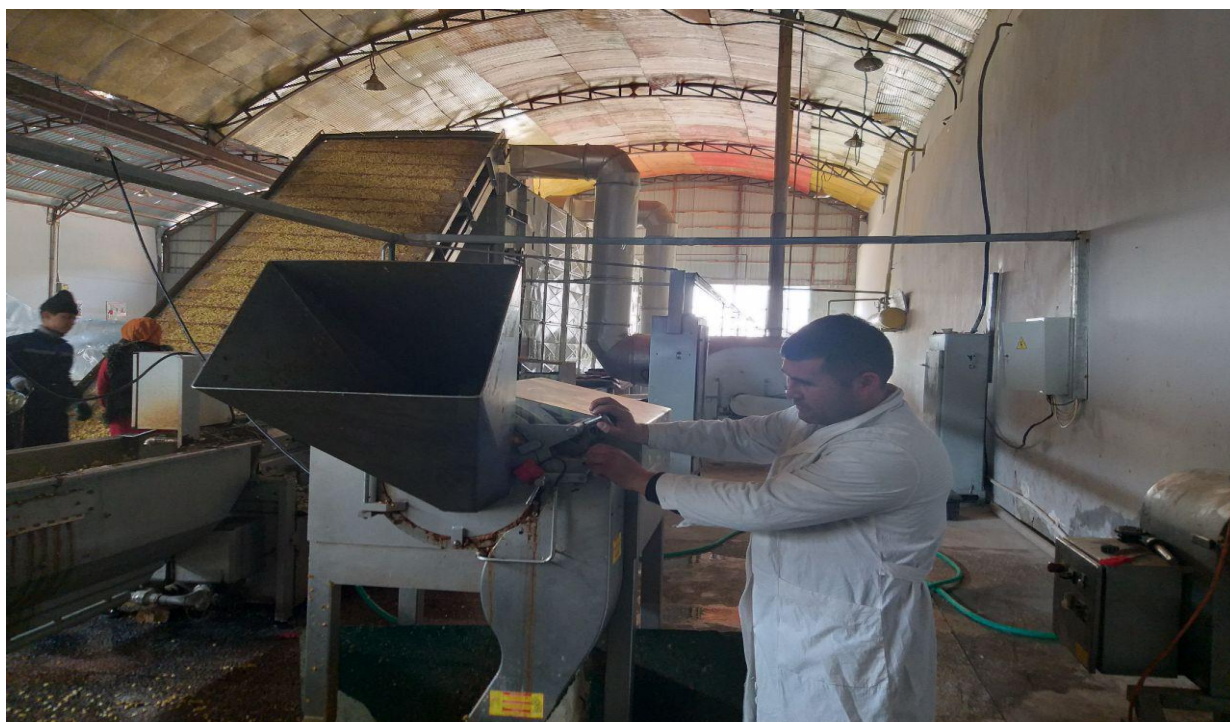
3.4.4.-rasm. Karamlarni kesish mashinasi.
