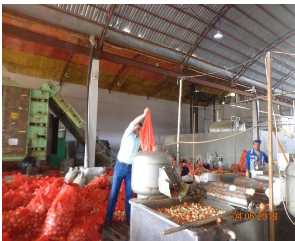
2.5.1-rasm. Piyozlarni yuvish mashinasi.
