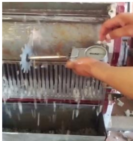
6.14-расм. Жин ишчи камераси ён томонига ўрнатилган мосламаларнинг ва ишчи камеранинг олд фартугининг тирқиши орқали хом ашё валигини айланиш тезлигини айланма ҳаракат берилганда тахометр билан ўлчаш жараёни
