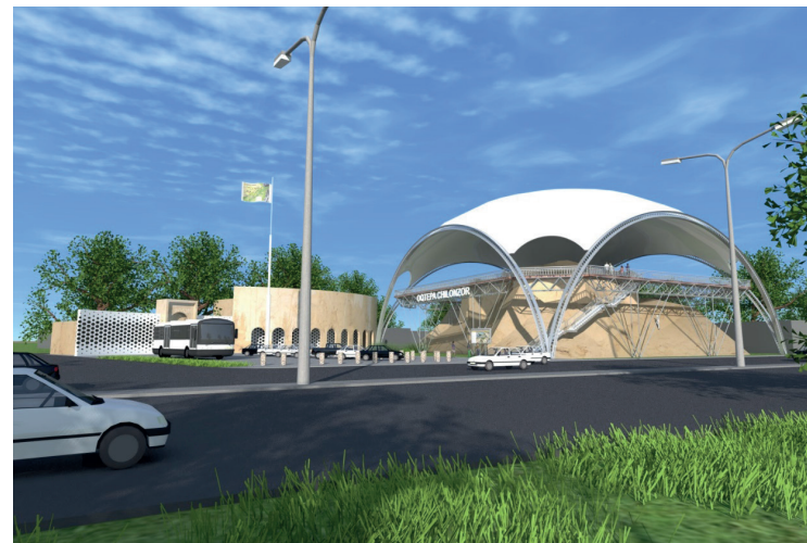
13-rasm. Chilonzor Oqtepa arxeologo-arxitekturaviy yodgorligining ustiga yopiladigan membrana konstruksiyasi
