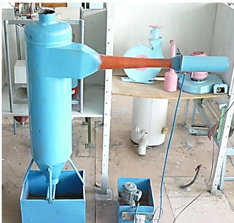
4.1-расм. Ҳўл усулда чанг ушловчи лаборатория қурилмаси.
