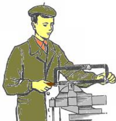
99 – rasm. Chilangarlik arrasi bilan ishlashda gavda va qo'llarning holati.
