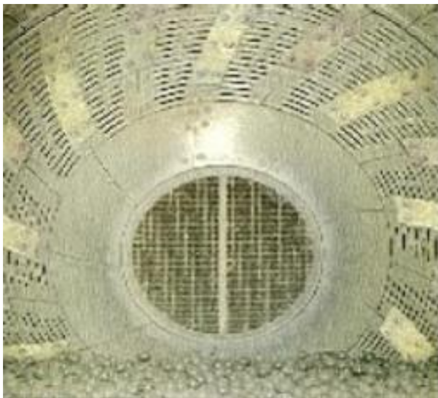
2.5 –расм. Шарли тегирмоннинг ички кўриниши.
