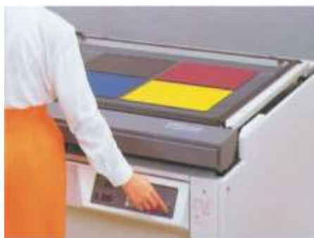
9.1-rasm. Analogli svetoproba: rangi ranglarga ajratilgan rasmga mos keladigan varaqlar oq taglikka aniq o'rnatiladi
