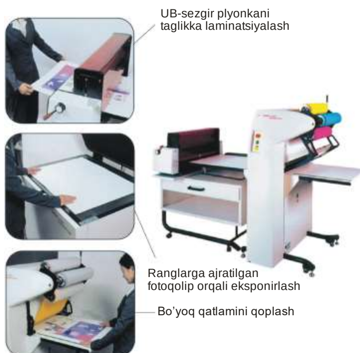
9.3-rasm. Ranglarga ajratilgan fotoqoliplardan olinadigan analogli svetoproba
