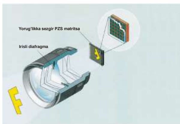
8.5-rasm. Fotoapparat ob'ektivi yordamida yorug'likka sezgir elementda optik rasmni shakllantirish
