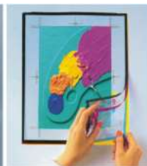
9.1-rasm. Analogli svetoproba: rangi ranglarga ajratilgan rasmga mos keladigan varaqlar oq taglikka aniq o'rnatiladi
