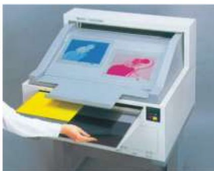
9.1-rasm. Analogli svetoproba: rangi ranglarga ajratilgan rasmga mos keladigan varaqlar oq taglikka aniq o'rnatiladi
