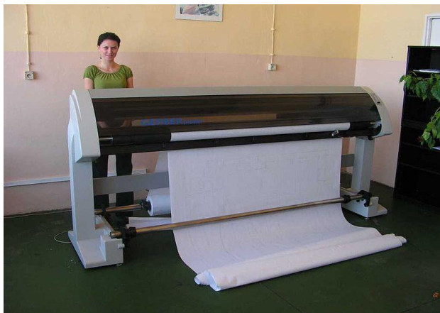
7.6.1-rasm. Grafa tuzib chiquvchi - plotterning umumiy koʻrinishi
