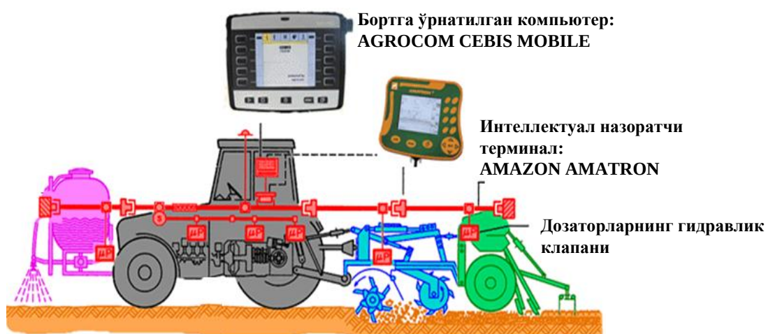
10.7.3.4-rasm. Sozlangan priyomnikli bo‘rtga o‘rnatilgan kompyuter
