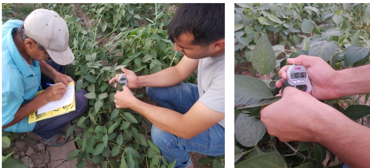
9- rasm. Barg qalinligini elektron Tolshinomer yordamida aniqlash jarayoni
