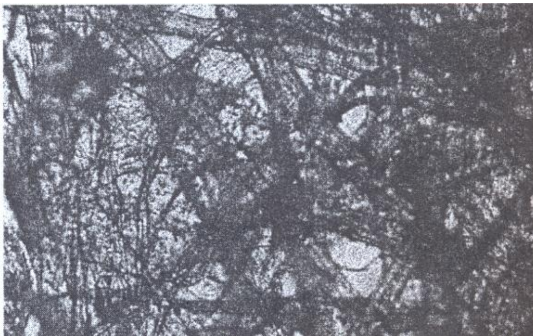
19-расм. Асос қоғознинг толали структураси
