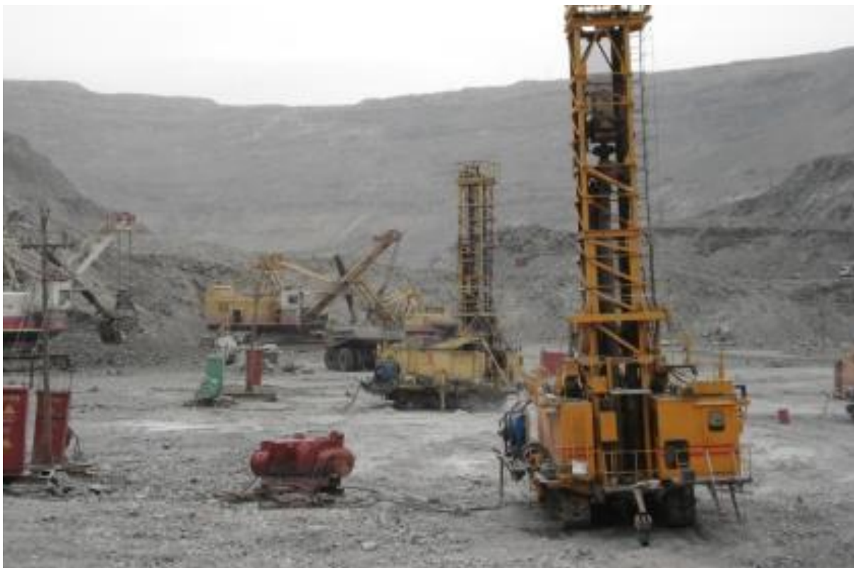
2.5-rasm. Karyerlarda sharoshkali burg'ilovchi stanok yordamida quduqlarni burg'ilash
