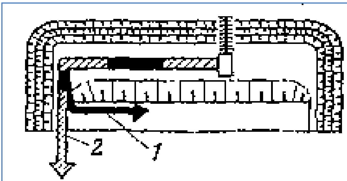
4.7-rasm. Elementar yuk oqimlari sxemasi: 1 – qoplovchi tog‘ jinsi; 2 – foydali qazilma; 3 – navbati bilan o‘zgargan holatda qoplovchi tog‘ jinsi va foydali qazilma.
