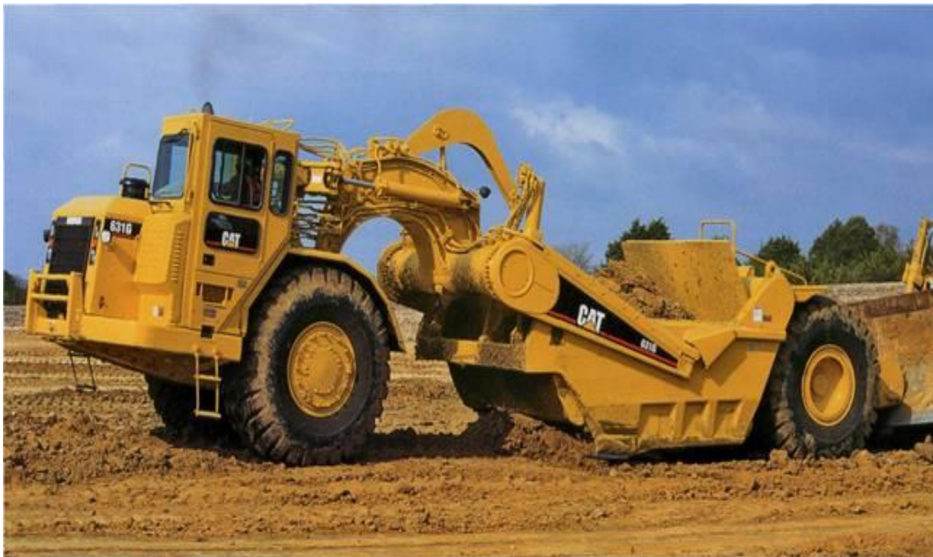
3.9-rasm. Skreperning umumiy ko‘rinishi
