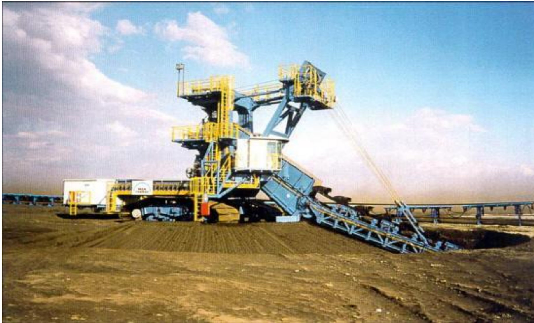
3.20-rasm. Zanjirli ekskavatorning umumiy ko‘rinishi.
