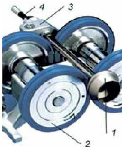
1.2-rasm. Yigirish kamerasiga harakat uzatish mexanizmi. 1-rotor; 2-tayanch roliklar; 3-havo yostiqli podshipniklar; 4-siqilgan havo uzatish naychasi.
