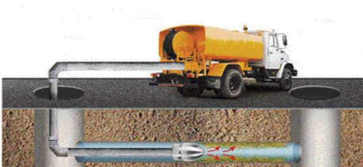
5.3 -расм.Тармоқларни гидродинамик тозалаш услуби
